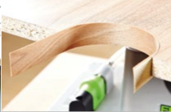
Innenradius bis 50 mm, minimaler Außenradius von 25–30 mm ▶
