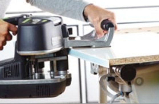
Kantenhöhe von 18–65 mm, Kantestärke von 0,5–3,0 mm ▶
