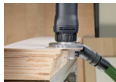
Fazowanie doklejek z tworzywa sztucznego lub drewna litego.
