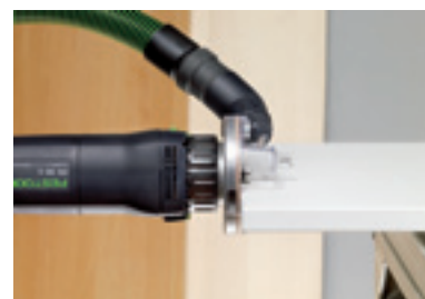
Zaokrąglanie doklejek z tworzywa sztucznego lub drewna litego.
