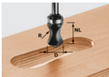
Frez do uchwytów, HW z łożyskiem kulkowym, trzpień 8 mm
