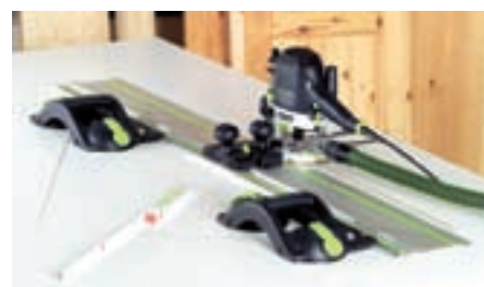
Z GECKO prościej staje się także frezowanie wpustów w przedmiotach o gładkiej powierzchni: należy tylko zamontować adapter i przymocować przyssawkami.
