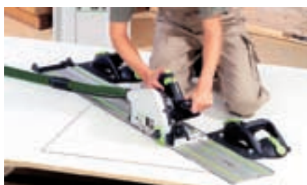
Pewne i czyste mocowanie: po prostu przymocować adapter do szyny prowadzącej, natożyć GECKO, zamocować – gotowe.
