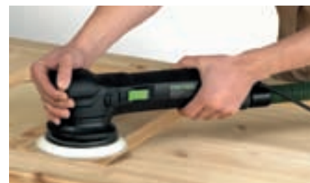
Szybkie: zdzieranie dzięki dużej intensywności, jaką zapewnia przekładnia.
