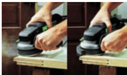
Tutaj widzą Państwo, co daje dobre odsysanie: mniej pyłu w powietrzu, a więc i mniej pyłu w płucach.
