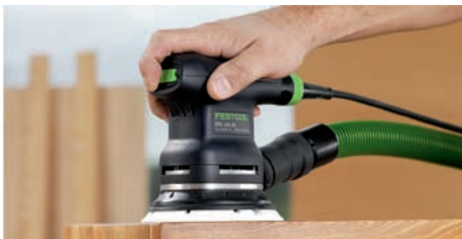
Spokojne i kontrolowane szlifowanie: system wyważenia antywibracyjnego VS Festool oraz ergonomiczne ukształtowanie obudowy w miejscu uchwytu podnoszą standardy bezpieczeństwa i komfortu pracy.
