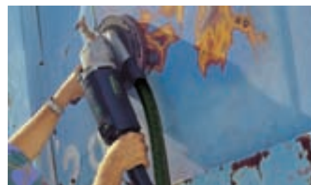
Na dużych powierzchniach z grubymi powłokami lakieru RAS 180 może w pełni spożytkować swoją wielkość i siłę.
