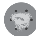
Typowy talerz szlifierski: zatkany pyłem po 1 s, wolny od pyłu po 6 s
