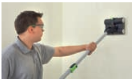
Ustawienie głębokości zabezpiecza podłoże.
