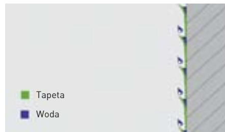
Zasada działania urządzenia FAKIR (zerwana tapeta widoczna z boku).
