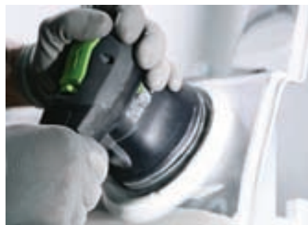
Zeszlifowywanie elementów karoserii przy użyciu pneumatycznej szlifierki mimośrodowej Festool.
