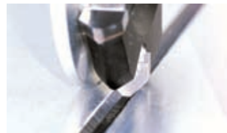
Rolka prowadząca zapewnia precyzyjną głębokość frezowania. Frez może tylko tak głęboko wejść w materiał, na ile pozwala mu rolka prowadząca.
