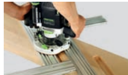
Za pomocą MFS można również dokładnie frezować stopnie schodów w belkach policzkowych.
