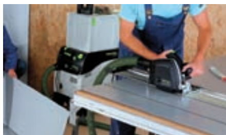
Wióry i pył są skutecznie odsysane za pomocą węża ssącego o średnicy 36 mm oraz odkurzacza Festool.
