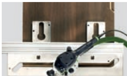
Z kolei szablon do łączenia blatów kuchennych pozwala na sprawne wykonywanie połączeń w narożnikach, czyli pod kątem prostym, oraz na prostej płaszczyźnie płyt.
