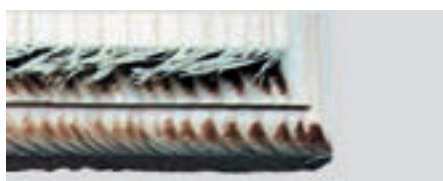
Frezowanie ze śladami przypalenia.
