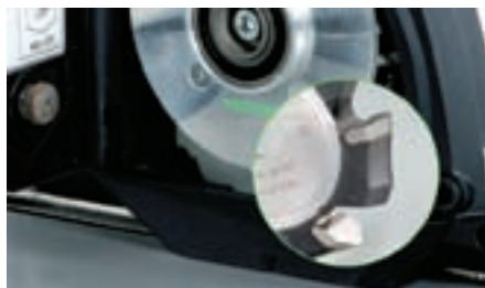
Frez do wpustów „V” i rolka prowadząca są wymienne. W ten sposób można w każdym momencie dostosowywać PF 1200 do różnych grubości materiałów.
