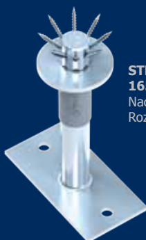
STF 330 125-160 mm Nacisk: 70,42 kN Rozciąganie: 16,23 kN
